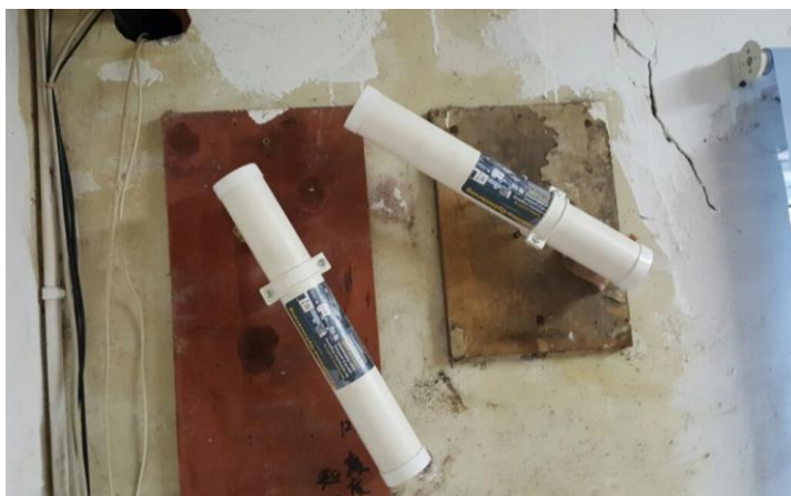
Hier das Strahlensymbol für das markierte Rohrende (siehe dort gleiches Symbol zu finden) und unten folgend eine peilende V-Stellung zweier MHRs; dabei vorzugweiser Öffnungswinkel um 30-40Grad.
